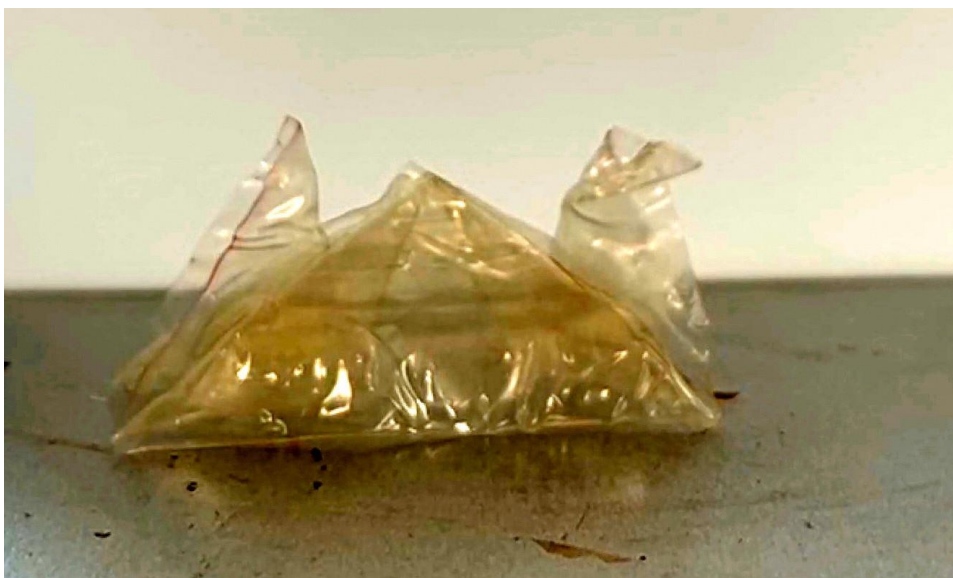
Figure 2 : L'origami VPR en forme de grue reprend sa forme initiale après avoir été chauffé.
